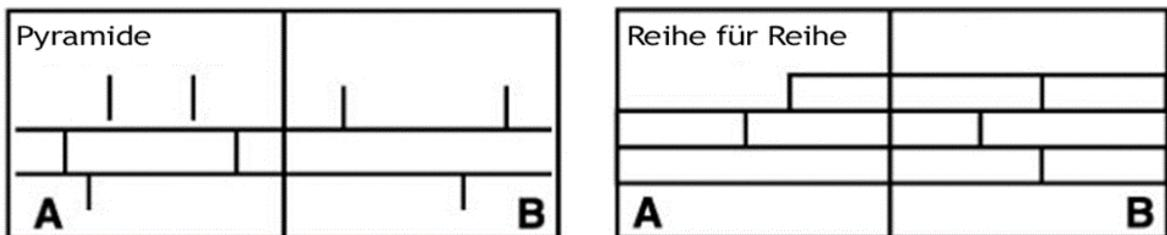
Bei einem normalen Raum haben Sie etwa 5% Verschnitt. Bei Fluren sind es etwa 7 – 10%. Beachten Sie dies bei der Beschaffung der Dielen. Der Verschnitt beim Fischgräten-Design liegt etwa bei 10 – 12%.
