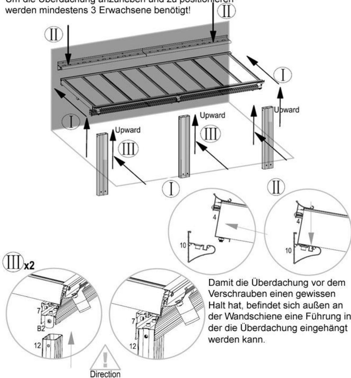
Damit die Überdachung vor dem Verschrauben einen gewissen Halt hat, befindet sich außen an der Wandschiene eine Führung in der die Überdachung eingehängt werden kann.
