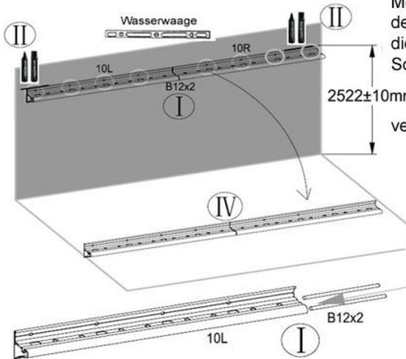
Montieren Sie vor Aufbau der Terrassenüberdachung die Wandschiene. Zum Schluss wird die gesamte Überdachung auf diese Schiene gelegt und verschraubt.
