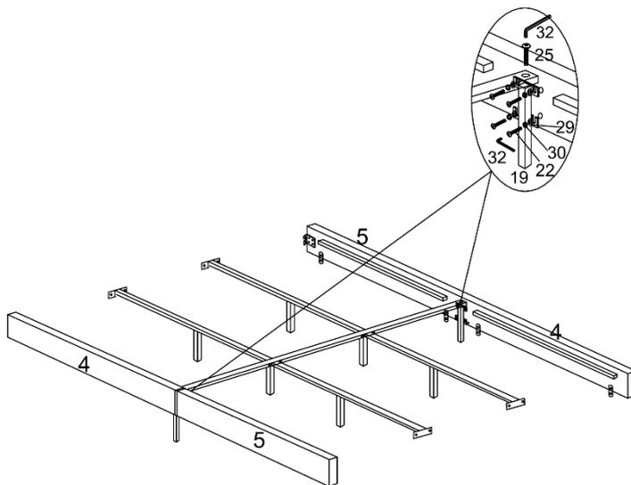
**Schritt 3:** Verschraube die Abstützung (19) mit den Schrauben (22), (25), den U-Scheiben (29) und Federscheiben (30) an die Seitenteile (4), (5).
