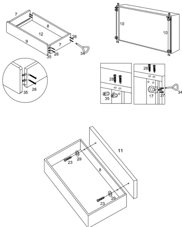
**Schritt 6:** Montiere die Möbelverbinder (35) in den Schubladenseiten. Montiere den Schubkasten mit den Komponenten (7,8,9,12), achte darauf, dass der Schubladenboden (12) in die Nuten der Schubkastenkomponenten (7,8,9) montiert wird. Verschraube alle Komponenten mit den Schrauben (28).
