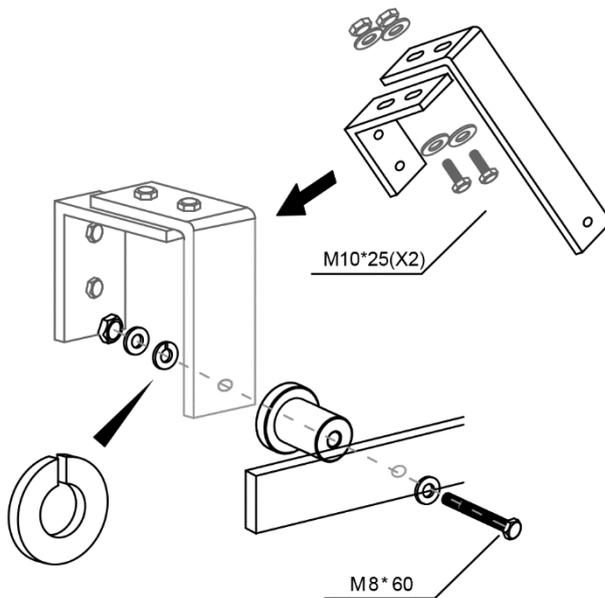
**Schritt 9a: Winkelverbinder montieren**
