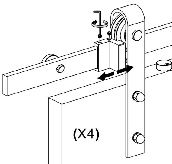
**Schritt 16: Türanschlag montieren**
