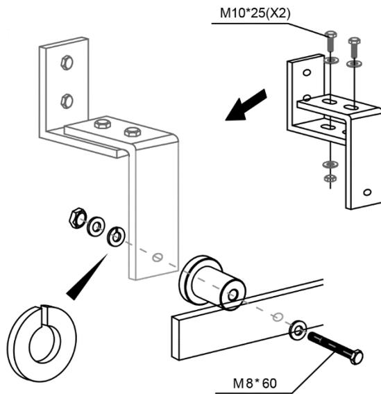
**Schritt 7a: Winkelverbinder montieren**
