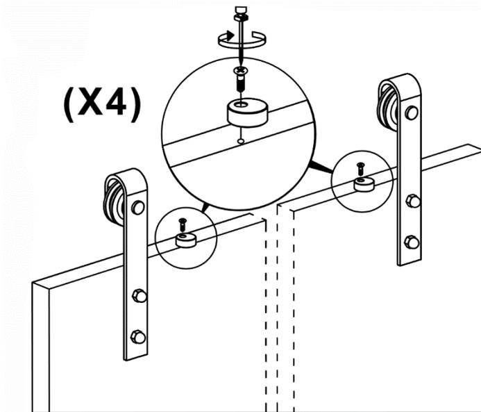
**Schritt 11: Absturzsicherung montieren**
