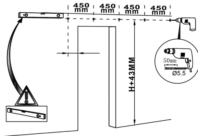
**Schritt 8a: Wand vorbohren**
