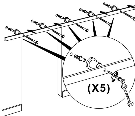
**Schritt 6b: Laufschiene an die Wand schrauben**
