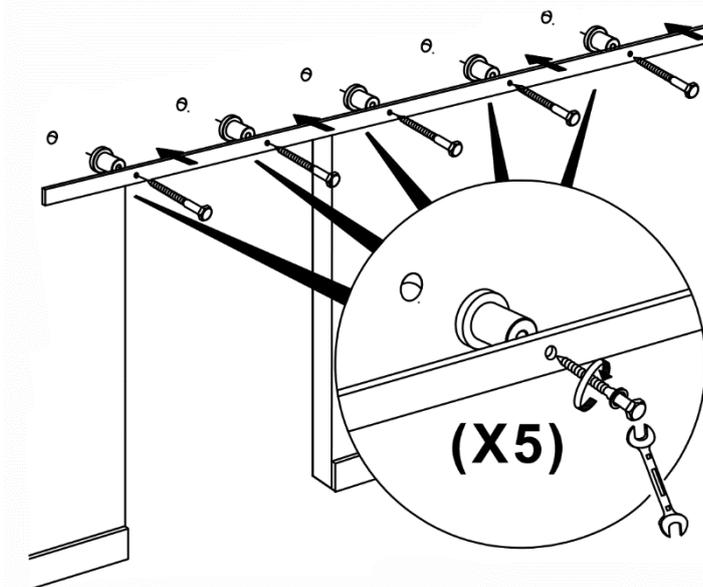
**Schritt 8b: Laufschiene an die Wand schrauben**
