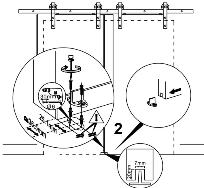
**Schritt 13: Bodenführung montieren**
