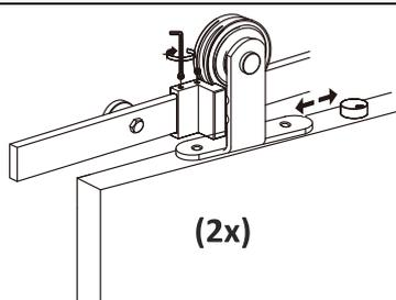
**Schritt 11: Türanschlag montieren**
