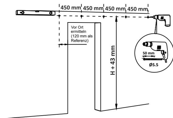
**Schritt 5a: Montage an einer Trockenbauwand mit Tragkonstruktion**
