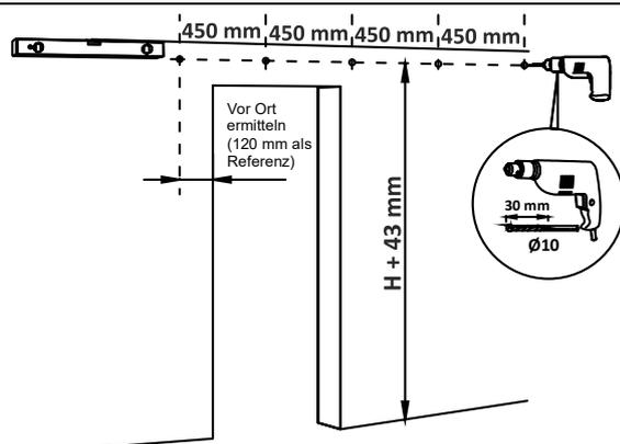
**Schritt 4a: Montage an einer gemauerten Wand**
