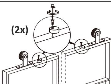
**Schritt 7: Absturzsicherung montieren**
