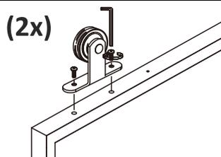
**Schritt 6: Laufrolle montieren**
