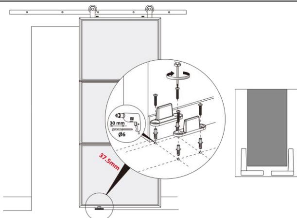
**Schritt 10: Bodenführung montieren**
