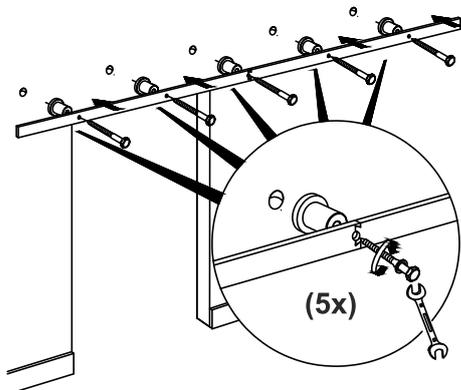
**Schritt 5b: Laufschiene an die Wand schrauben**
