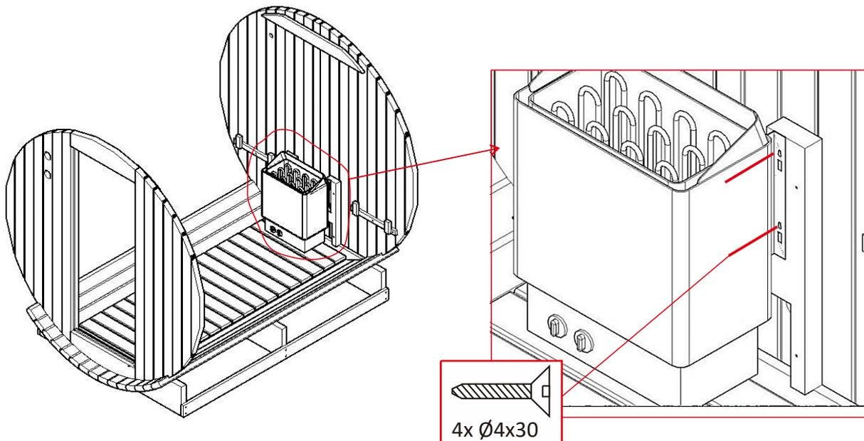
**Achtung:** Der Saunaofen **muss** in einem Abstand von 90 mm vom Fußboden an der Rückwand montiert werden.
