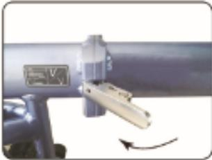
Lösen Sie die Vorbau-Klappsperre (wie durch den Pfeil in der Abb. dargestellt)
