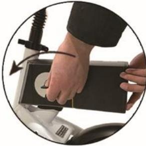
2. Ziehen Sie die Batterie nach hinten, um die Batterie zu entfernen.
