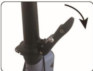
Klappen Sie den Vorbau nach unten (wie durch den Pfeil in der Abb. dargestellt), um die Faltung abzuschließen.
